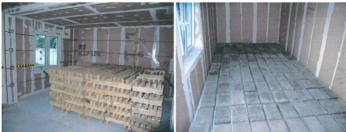
Rys. 12. Po lewej: stos drewna stanowiący źródło ognia w scenariuszu P3; po prawej: obciążenie użytkowe stropu nad źródłem ognia.
