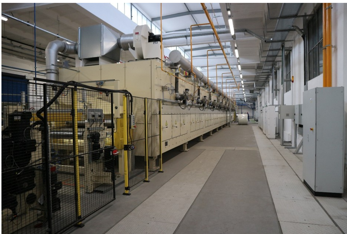
Oddział Adfors w Gorlicach, linia produkcyjna welonu powlekanego. Fot. Adfors
